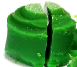
شکل ۳ - تصویری از آنروژل اکسید نیکل پیش از کلسینه شدن
