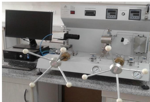
شکل ۱ - تصویر دستگاه اندازه‌گیری کشش بین سطحی مورد استفاده
