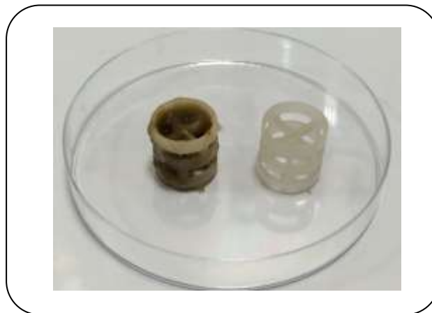
شکل ۶ - تشکیل فیلم زیستی میکروبی در سطح پرکن پال رینگ.
