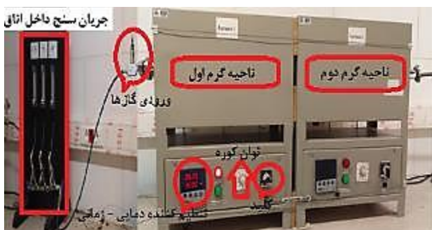
شکل ۵ - شمایی از دستگاه رسوب‌دهی شیمیایی بخار در فشار اتمسفری مورد استفاده
