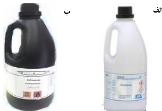
شکل ۳ - محلول‌های (الف) استون و (ب) ایزوپروپانول با خلوص ۹۹ درصد برای شستشوی زیرلایه‌های سیلیکونی (Si)
