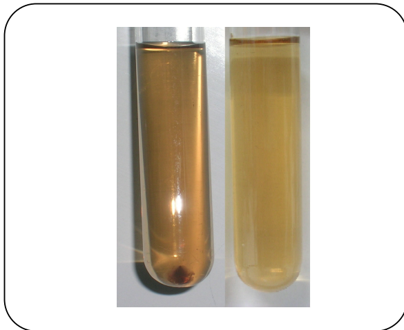
شکل ۱- رسوب دارای ماده امولسیون کننده پس از سانتریفوژ.
