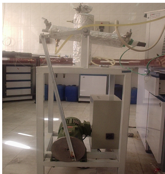
شکل ۱- دستگاه آزمایش تولید و تجزیه هیدرات گازی.
