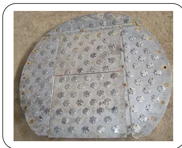
شکل ۲- تصویر سینی دریچه‌ای مورد آزمایش قرار گرفته.
