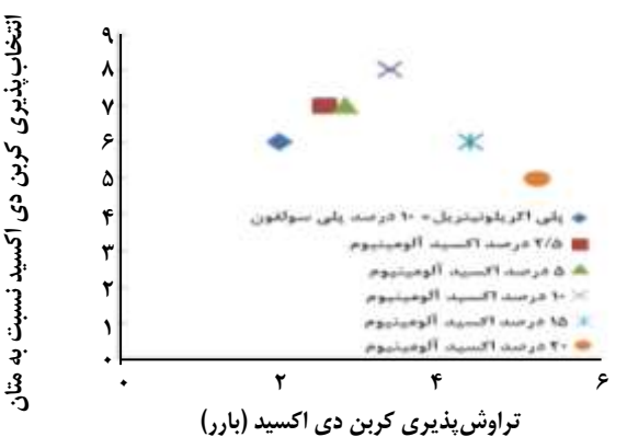
شکل ۶ - مقایسه‌ی بین تراوش پذیری کربن دی اکسید و انتخاب پذیری کربن دی اکسید نسبت به متان برای غشاهای نانوکامپوزیت پلی اکریلونیتریل مخلوط با درصد پلی سولفون و این غشا با ۲/۵، ۵، ۱۰، ۱۵ و ۲۰ درصد آلومینیوم اکسید.
