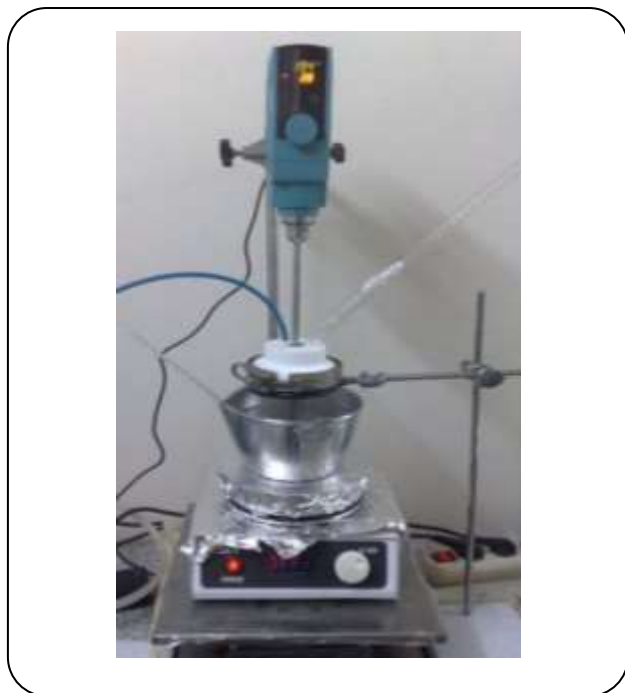
شکل ۱- تصویری از راکتور آزمایشگاهی مورد استفاده در تهیه پلی‌یورتان.
