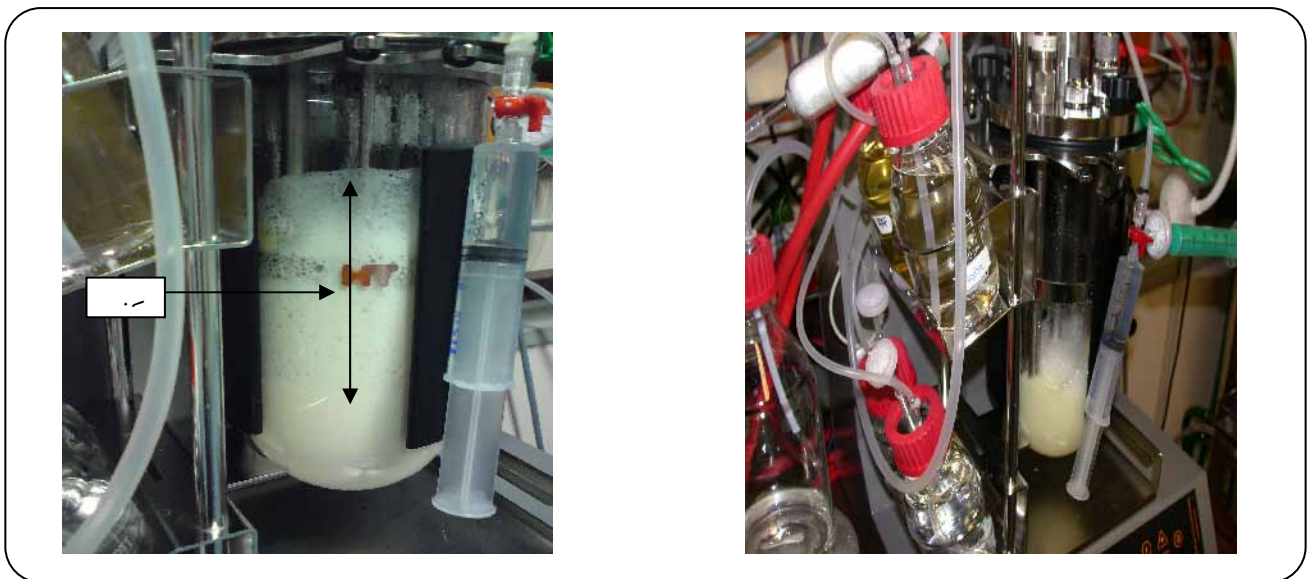
شکل ۴- راکتور زیستی در حال تولید رامنولیپید و کف به وجود آمده در آن.
