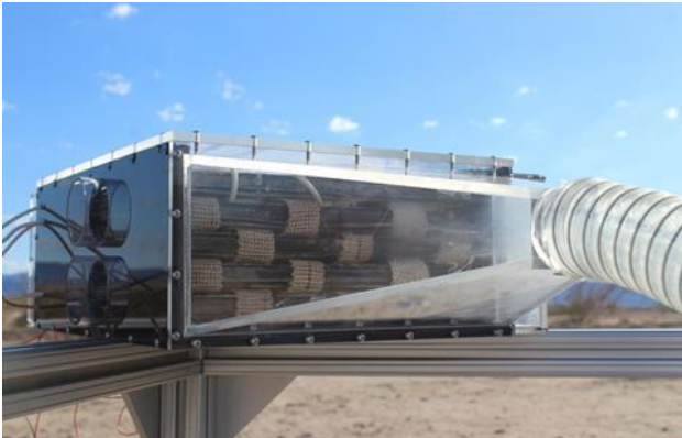
شکل ۲۱ - شماتیک دستگاه جمع‌آوری آب دانشگاه برکلی [M.P.U] [۲۰۶].
