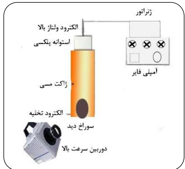
شکل ۱- نمایشگر کلی از یک محفظه استوانه‌ای تحت میدان الکتریکی غیر یکنواخت جهت شکست امولسیون و یا تلاقی قطره‌ها به هم می‌باشد.
