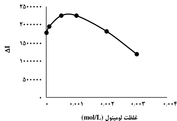
شکل ۹ - تأثیر غلظت لومینول در واکنش نورتابی شیمیایی لومینول - اکسیژن مولکولی - نانوذره‌های \text{Co}_3\text{O}_4 . شرایط واکنش: سدیم هیدروکسید 0.1 \times 10^{-4} مولار، نانوذره‌های \text{Co}_3\text{O}_4 ۱۰۰ میلی‌گرم بر لیتر و کلوگزاسیلین 1 \times 10^{-4} مولار.
