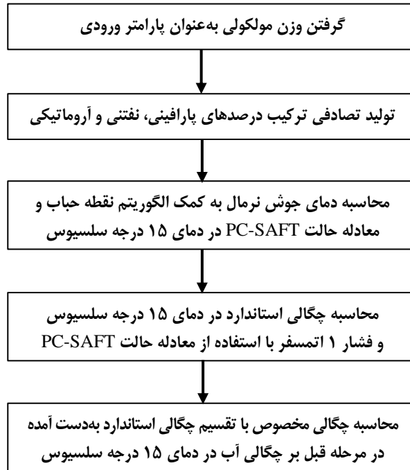
شکل ۱- فلوجارت ساخت مجموعه داده‌های برش‌های مصنوعی
