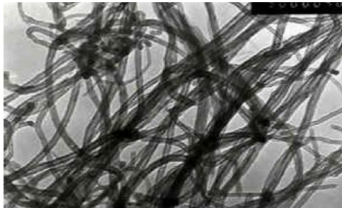
شکل ۲ TEM نانولوله‌ی کربنی خام
