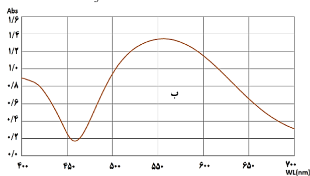
شکل ۲ - (الف) ساختار شیمیایی، (ب) طیف جذبی کمپلکس پالادیوم-PDR برای غلظت ده میلی گرم بر لیتر از پالادیوم و (ج) طیف جذبی شاهد در برابر آب مقطر
