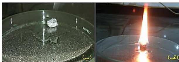
شکل ۱۱ - (الف) تخلیه روغن جذب شده به واسطه آتش زدن آئروژل‌ها. (ب) نمونه پس از تخلیه
