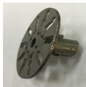
شکل ۳. پره همزن مورد استفاده در آزمایش‌ها
