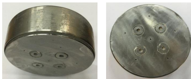
شکل ۲. توزیع کننده فاز گاز در راکتور حبابی
