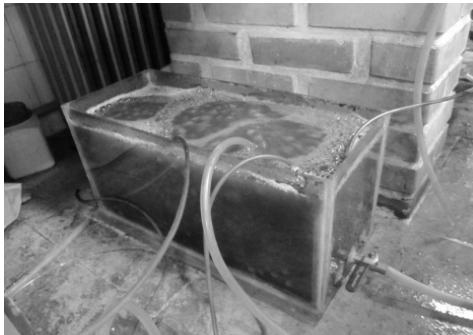
شکل ۴- الف) نمای کلی راکتور زیستی و صافی‌های داخل آن، ب) نمای کلی راکتور زیستی MBBR معمولی.
