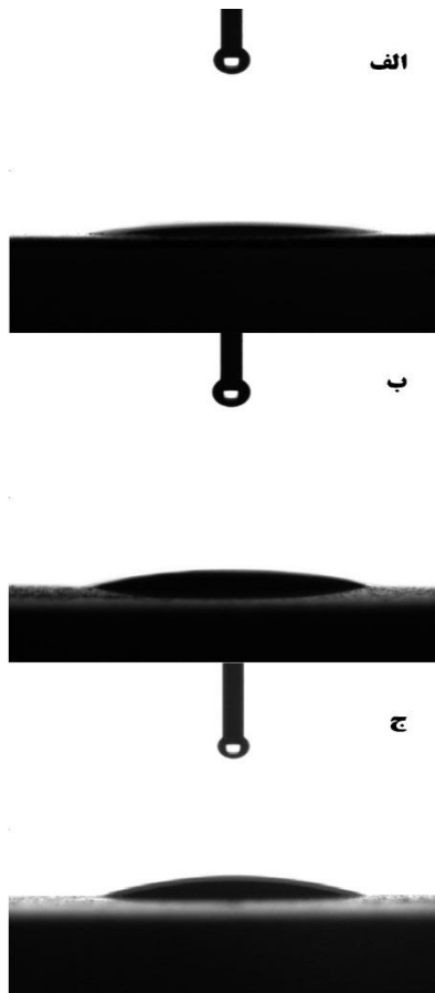
شکل ۴ - تصاویر حاصل از شکل قطره در شرایط مختلف سطح‌ساز، الف- عدم حضور سطح‌ساز، ب- در حضور سدیم دو دسیل سولفات، ج- در حضور سدیم لوریل اتر سولفات
