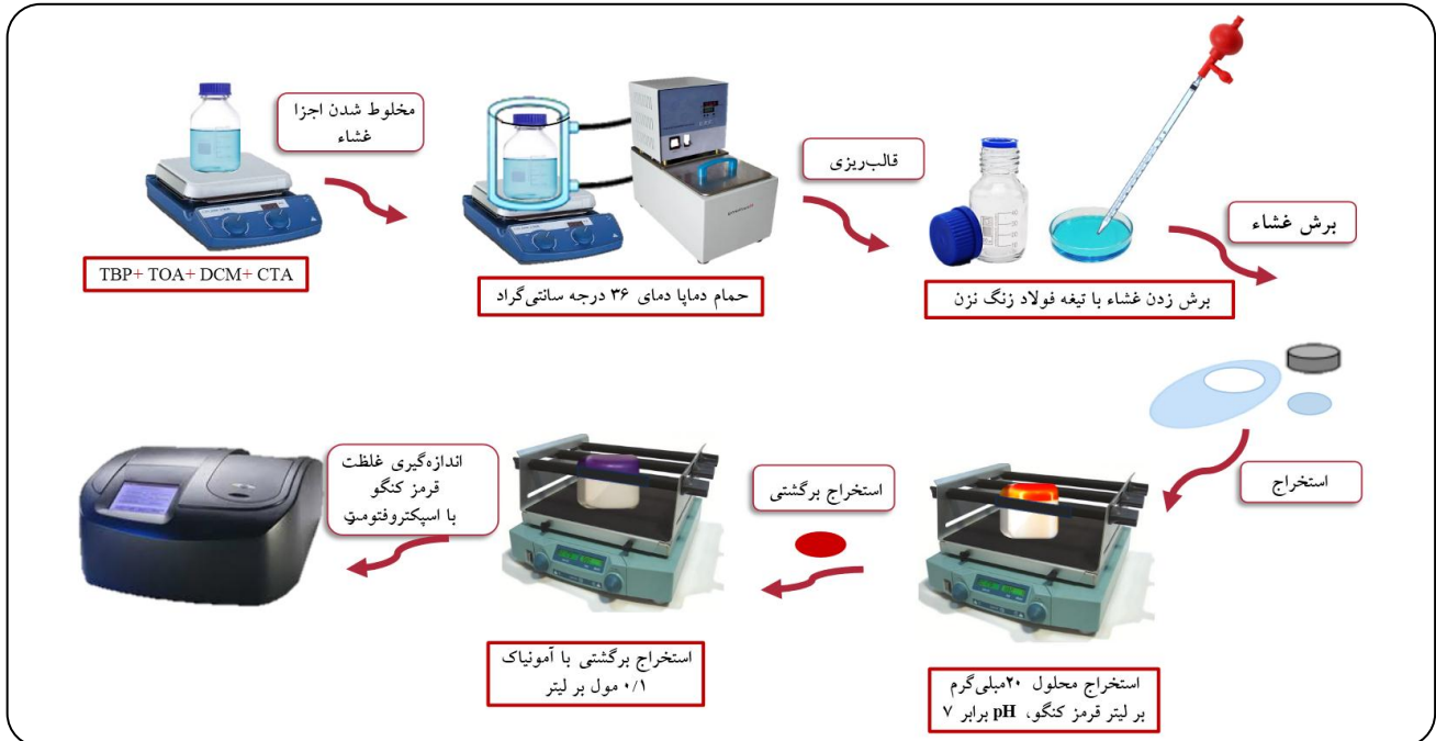
شکل ۲ - شمای مراحل تهیه غشای پلیمری درون گیر CTA/TOA/TBP و بکارگیری آن در فرآیند استخراج/استخراج برگشتی قرمز کنگو
