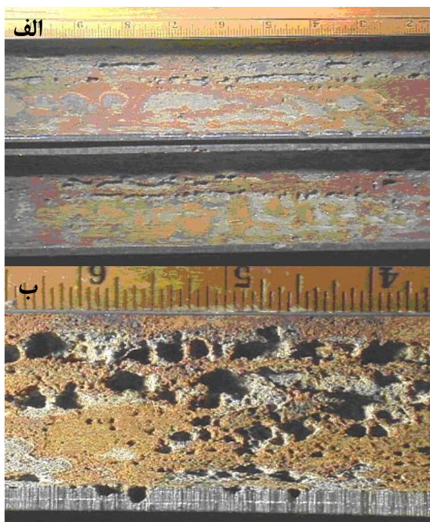
شکل ۴ - خوردگی \text{CO}_2 در خط لوله جریان تولید نفت و گاز از جنس فولاد کربنی در دو بزرگنمایی مختلف.
