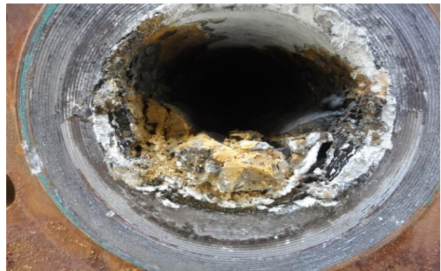
شکل ۵- تصویری از خوردگی زیر رسوبی در خطوط حاوی اسید فلوریدریک [۱۷]
