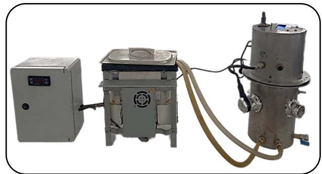
شکل ۴ - دستگاه آزمایشگاهی تشکیل رسوب
