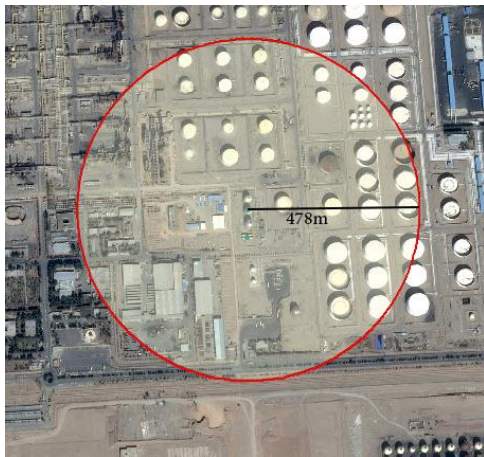
شکل ۲- بازه اثر سطح تابشی مستقیم منجر به سوختگی شدید در آتش کروی مخزن ۲۰۶۰
