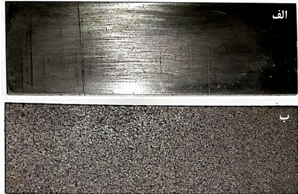
شکل ۱- صفحه استیل صیقل زده شده (الف) قبل از سند بلاست، (ب) صفحه بعد از سند بلاست
