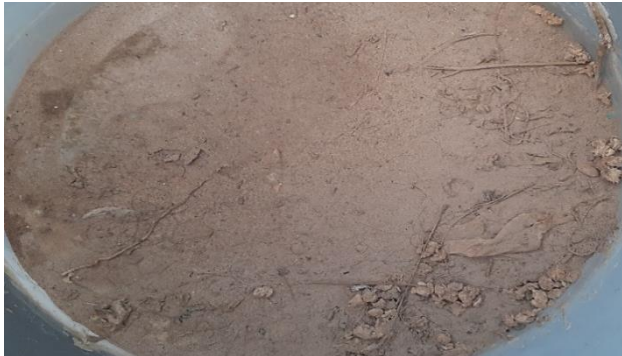
شکل ۷ - تصویری از لجن باقی مانده نفتی پس از تمیز کردن و خشک شدن
