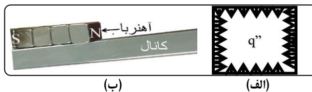
شکل ۱ - الف) جهت انرژی گرمایی کل اعمالی، ب) روش قرار گیری آهنرباها بر روی کانال قطب‌های آهنربا
