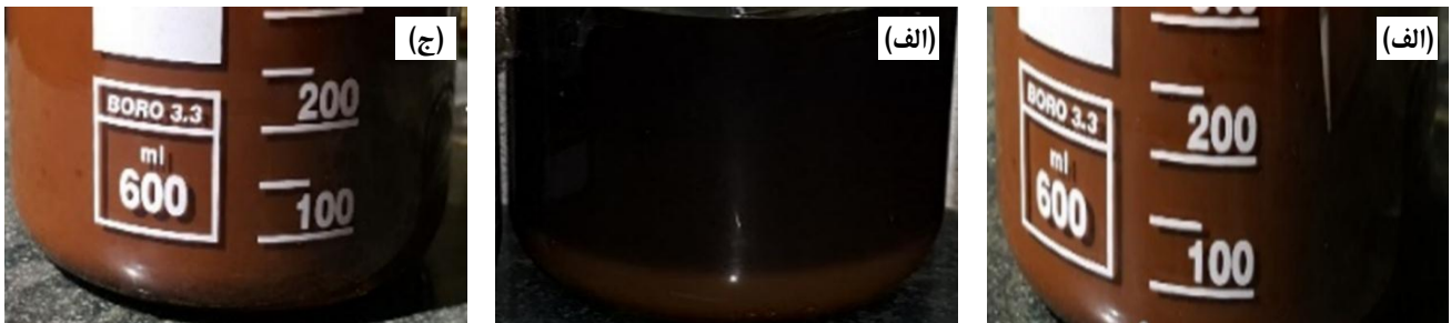
شکل ۵ - فروسیال، ۱٪ϕ، (الف) ۵ روز پس از تولید (ب) ۷ ماه پس از تولید (ج) ۷ ماه پس از تولید و ۵ روز پس از انجام فراصوت
