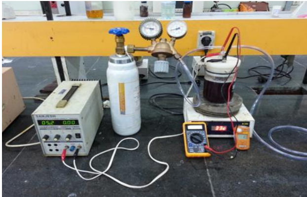
شکل ۱- پایلوت طراحی شده جهت حذف گاز هیدروژن سولفید به روش درجا به وسیله یون فرات .
