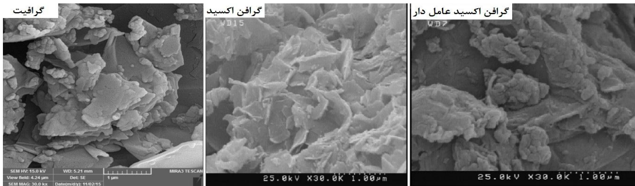
شکل ۴- تصاویر FE-SEM گرافیت، گرافن اکسید و گرافن اکسید عامل‌دار شده با پلی‌اکریلامید
