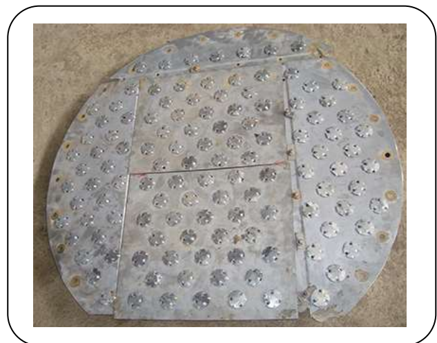
شکل ۲- تصویر سینی دریچه‌ای مورد آزمایش قرار گرفته.
