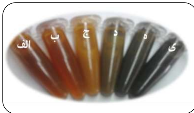
شکل ۱ - تغییرهای رنگ محلول واکنش با گذشت زمان (الف) ۲ (ب) ۴ (ج) ۵ (د) ۶ (ه) ۸ (ی) ۲۰ ساعت از آغاز واکنش
