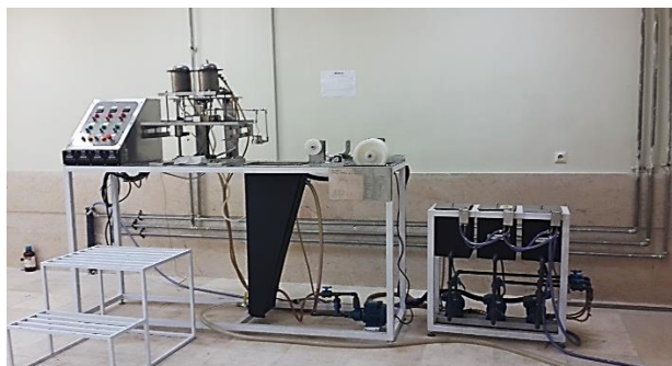
شکل ۱ - تصویر دستگاه ساخت غشای الیاف میان تهی
