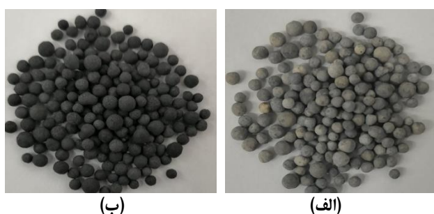
شکل ۷ - تصویرهای (الف) کاتالیست‌های تازه و (ب) کک دار شده با استفاده از روغن سبز در دمای ۴۵۰°C
