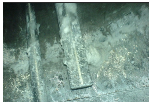
شکل ۶ - همزن آلوده در آزمایش PVA3.
