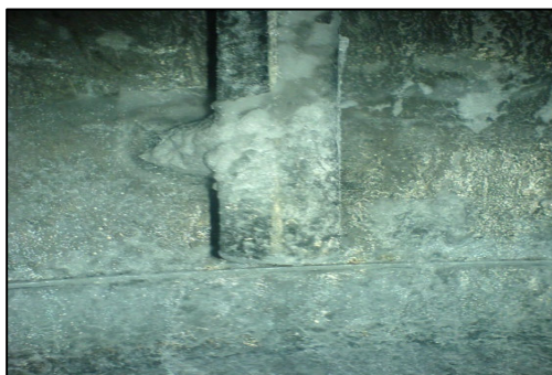
شکل ۸ - بافل آلوده در آزمایش PVA5.
