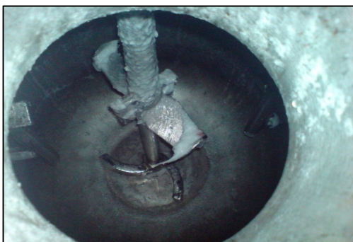
شکل ۷- بافل و دماسنج آلوده در آزمایش PVA3.
