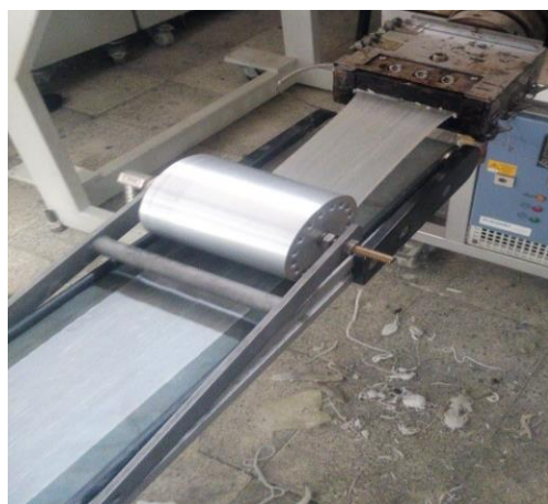
شکل ۲- تصویری از فیلم آمیخته نشاسته تهیه شده با فرآیند اکستروژن
