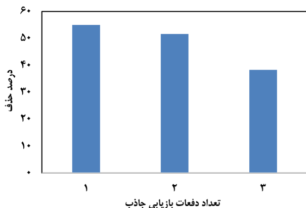
شکل ۱۸- قابلیت استفاده مجدد از جاذب MIL-101(Cr)@ZnO در حذف متیلن بلو
