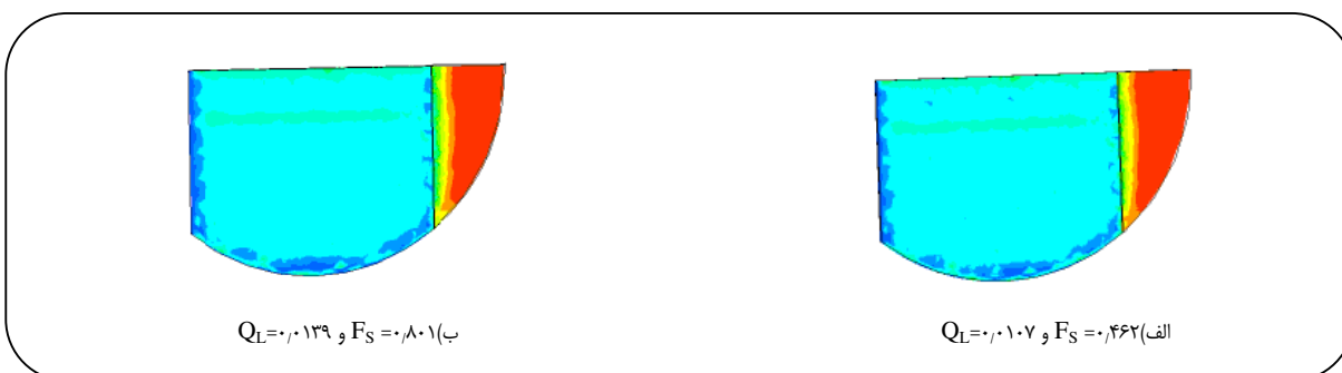
شکل ۴- کانتورهای جزء حجمی هوا در صفحه (Z-X) در ارتفاع ۰/۰۳۸ متر از کف سینی.
