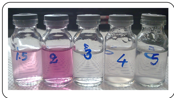
شکل ۱- نمایی از تفاوت رنگ شدید محلول‌های حاوی نانوذرات در اثر تغییر pH محیط واکنش. 5 \times 10^{-4} مولار Au(III) ، دمای ۲۵ درجه سانتیگراد زمان مجاورت ۵ ساعت.
