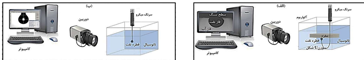
شکل ۲ - الف) شماتیک چگونگی اندازه‌گیری زاویه تماس، ب) چگونگی اندازه‌گیری کشش بین سطحی در حضور نانوسیال
