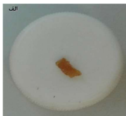
شکل ۱- تصویر دیجیتالی هیدروژل (الف) پلی (۱-وینیل ایمیدازول)، (ب) پلی (۱-وینیل ایمیدازول)-کواترنیزه شده
