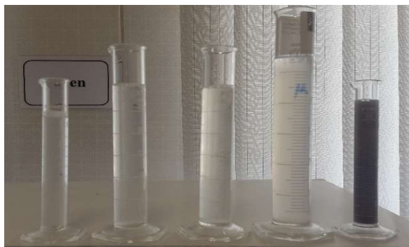
شکل ۲ - تست نیترات نقره واکنش سدیم مونت‌موریلونیت اصلاح شده با سورفکتانت HDTMA-Br
