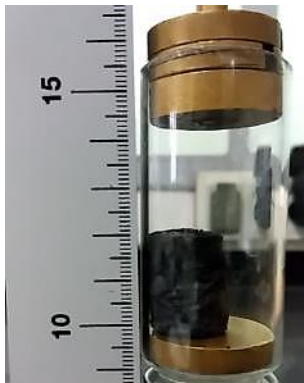
شکل ۳ - سامانه اندازه‌گیری ویژگی‌های مکانیکی آتروژل‌ها
