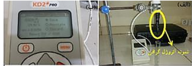
شکل ۱۰ - اندازه‌گیری رسانش گرمایی آئروژل گرافن (الف) سامانه اندازه‌گیری با دستگاه KD2 pro. (ب) مقدار رسانش گرمایی آئروژل گرافن
