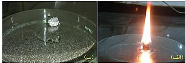
شکل ۱۱ - (الف) تخلیه روغن جذب شده به واسطه آتش زدن آئروژل‌ها. (ب) نمونه پس از تخلیه
