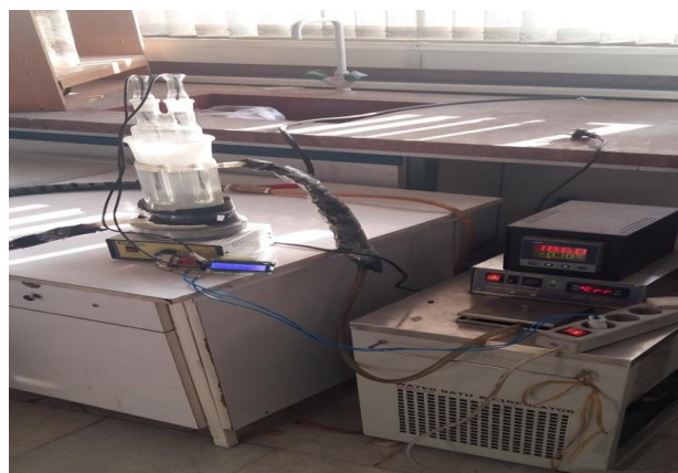
شکل ۲- دستگاه تولید و تجزیه هیدرات تتراهیدرو فوران
