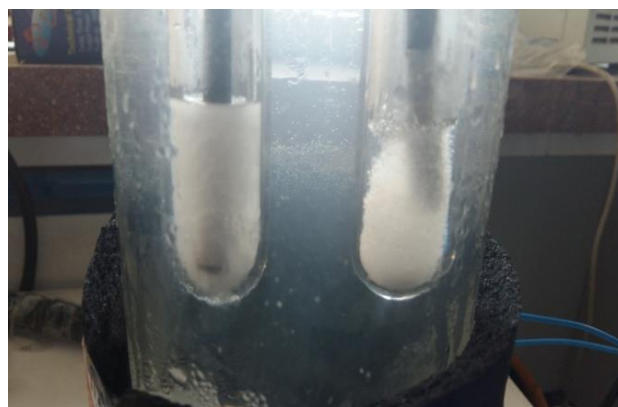
شکل ۱۰- تشکیل هیدرات تتراهیدروفوران در حضور ستیل تری متیل آمونیوم
