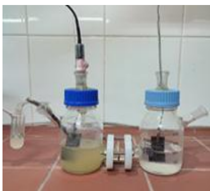
شکل ۴- نمای کلی از پیل سوختی میکروبی در این کار پژوهشی
