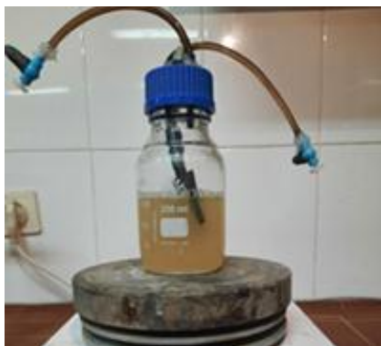
شکل ۳- نیم پیل آندی بعد از کشت باکتری به مدت ۲۴ ساعت.
