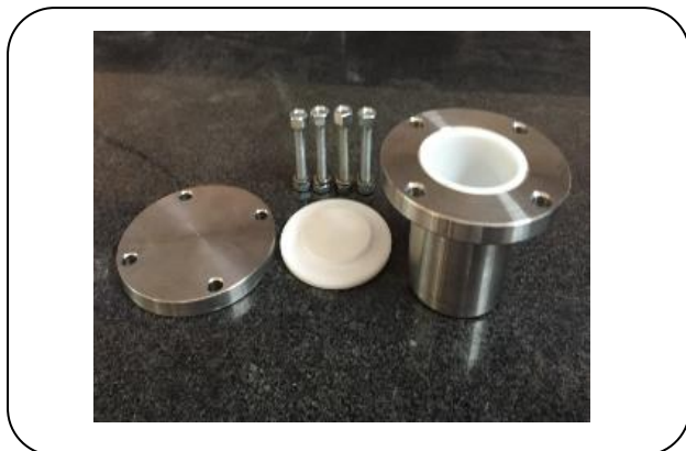
شکل ۱- اتوکلاو هیدروترمال ساخته شده برای سنتز نانو ذره‌های اصلاح شده \alpha\text{-Fe}_2\text{O}_3 .
