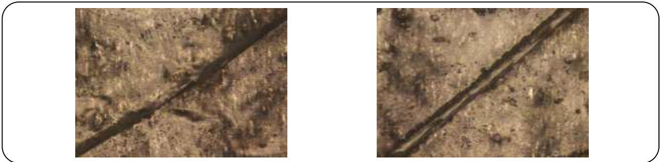
شکل ۷- تصویر میکروسکوپی نوری پوشش خودترمیم شونده (الف) پس از ایجاد خراش اولیه (ب) پس از گذشت ۳ روز از تماس با محلول.
