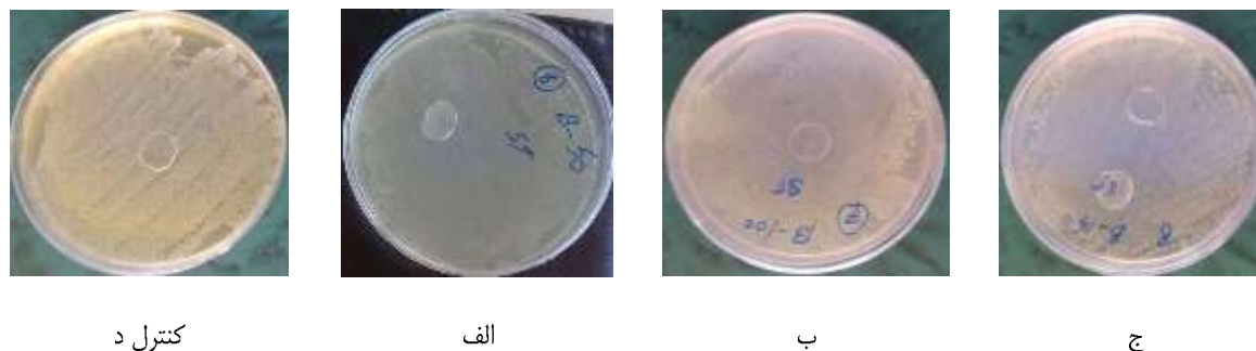
شکل ۹- ورقه کنترل (د) و ورقه های نانوکامپوزیت نقره - پلی استایرن انبساطی دیرسوز با غلظت های گوناگون نانو ذره های نقره (الف، ب و ج) در پتری دیش های دارای باکتری S. aureus ATCC 6538.
