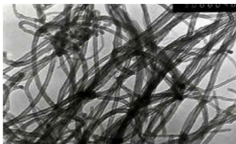
شکل ۲ TEM نانولوله‌ی کربنی خام
